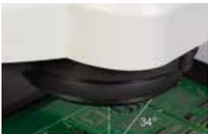
除了直接观察，它还能围绕特征进行 360 度旋转、以 34 度倾斜角观察，Lynx EVO 和 EVO Cam 两种系统均提供此功能。因此，无论是普通的上表面，还是特征周围的侧面细节，皆可轻松查看。对于焊点、孔、柱以及螺纹形状尤其实用。
